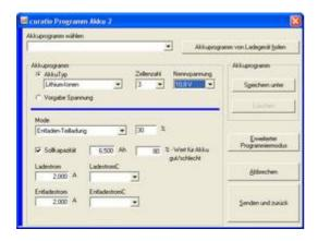
Beim Modus "Teilladung" wird keine Erhaltungsladung ausgeführt. Auf Akku defekt über die Akkuspannung und/oder über die gemessene Kapazität beim Entladen wird nicht geprüft.
